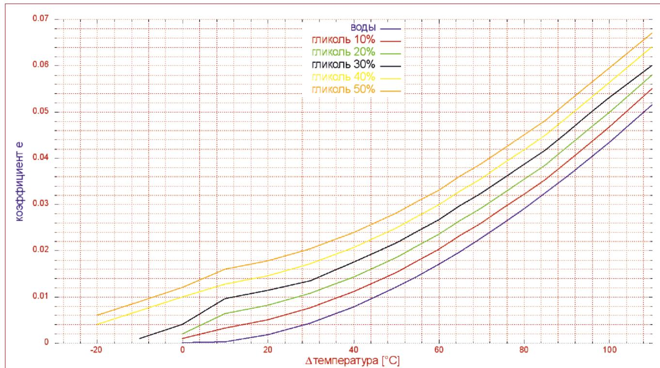
Отметим, что при растущем процентном содержании гликоля в смеси, при одинаковой разнице температур, растет и коэффициент термического расширения.
